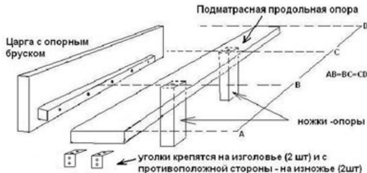
Чтобы отмерить высоту на которой крепятся уголки к изголовью и изножью, надо приставить вертикально, по центру, ножку-опору. Верхний край ножки-опоры указывает высоту крепления уголков на изголовье и изножье. Суть действий: - Продольная опора и горизонтальные опорные бруски на царгах должны быть на одном уровне.
